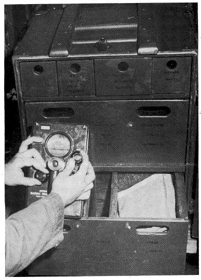
ION CHAMBER LOCATES RADIOACTIVITY
